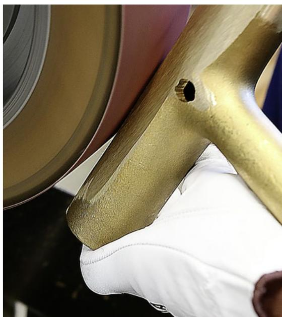
Beim Schleifen werden die Gusshaut, Unebenheiten und grössere Poren entfernt.
